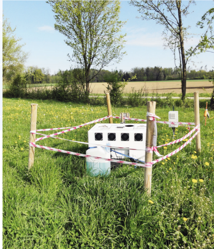
Abbildung 3: Windmessungen mit LiDAR in Dippishausen und in der Region Fischingen
