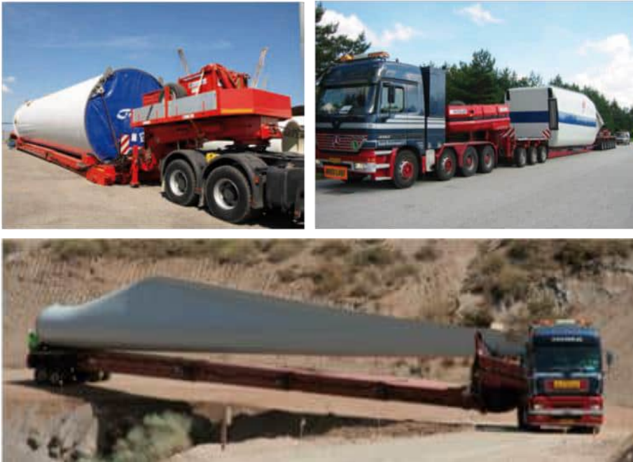
Abb. 7: Herkömmliche Transportfahrzeuge wie Kesselbrücken (oben links), Flachbettbrücken (oben rechts) und Semi-Trailer (unten); Quelle: Scheuerle.
