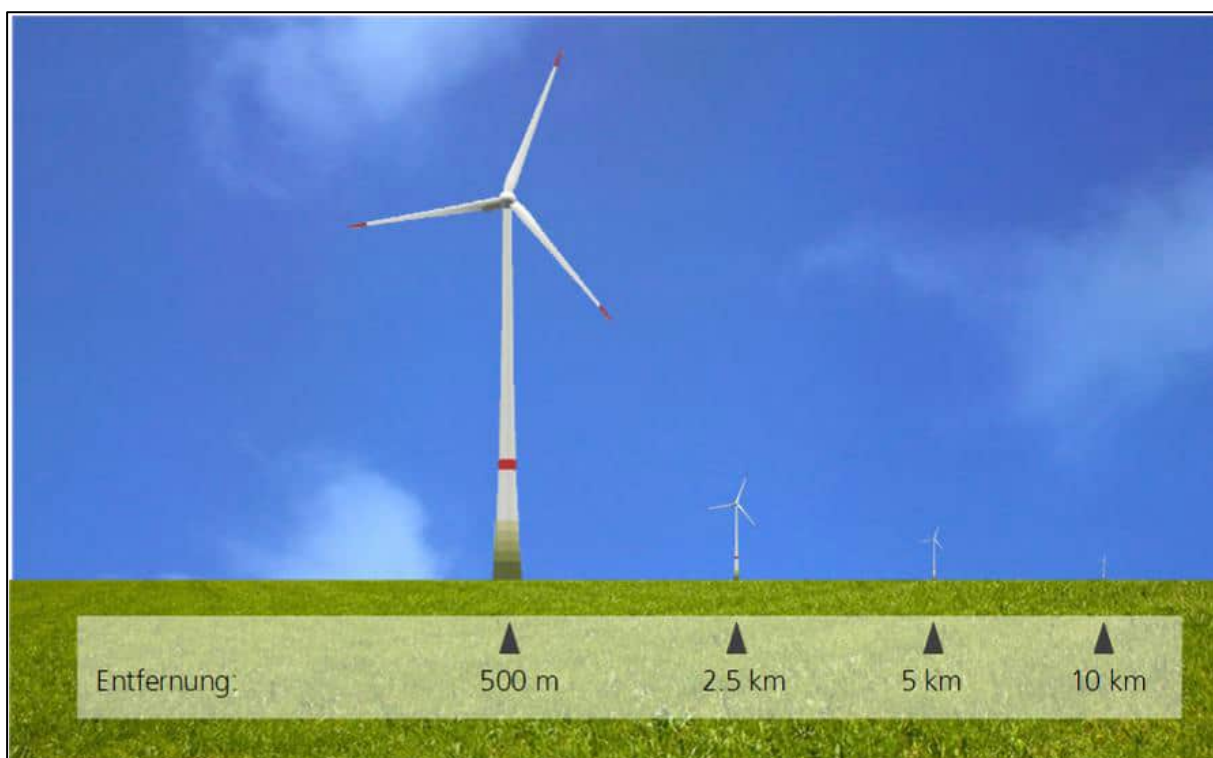
Abb. 10: Distanzabhängige Wirksamkeit einer WEA am Beispiel einer Enercon E-115 mit Nabhöhe 125 m und Rotordurchmesser 115 m. [3]
