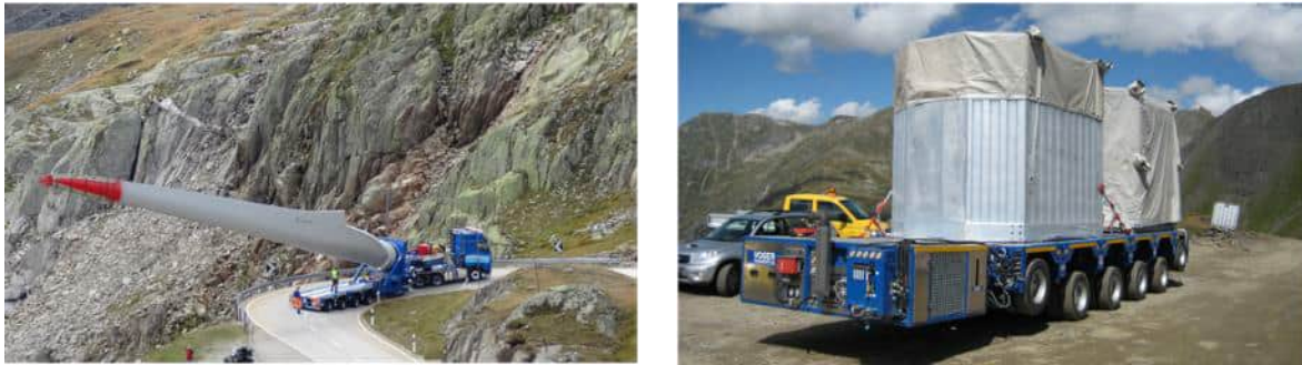
Abb. 8: Spezielle Transportkombination mit Schwanenhals (links) und Selbstfahrer M4 (rechts); Quelle: New Energy Scout.
