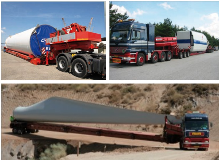
Abb. 1: Herkömmliche Transportfahrzeuge wie Kesselbrücken (oben links), Flachbettbrücken (oben rechts) und Semi-Trailer (unten); Quelle: Scheuerle.
