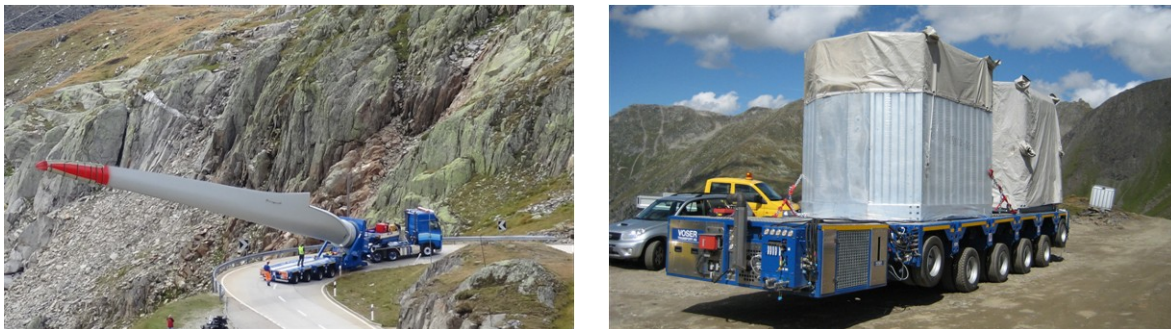
Abb. 2: Spezielle Transportkombination mit Schwanenhals (links) und Selbstfahrer M4 (rechts); Quelle: New Energy Scout.
